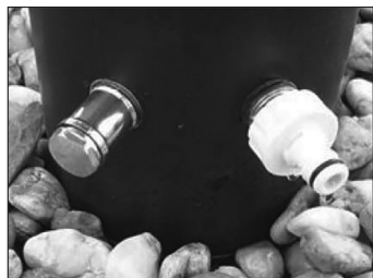
Auslassventil (links), wasseranschluss mit Schnellkupplung (rechts)
