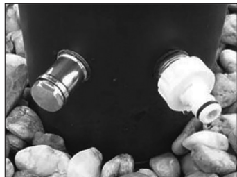
отвор за източване със запушалка (вяляво), входна арматура завършваща с маркуч (вдясно)
